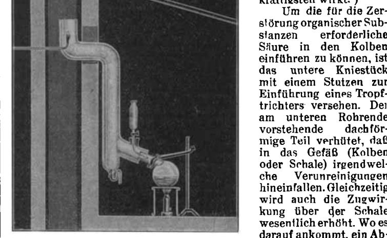
Um die für die Zersetzung organischer Substanzen erforderliche Säure in den Kolben einzuführen zu können, ist das untere Kniestück mit einem Stutzen zur Einführung eines Tropftrichters versehen. Der am unteren Rohrende vorstehende dachförmige Teil verhüttet, daß in das Gefäß (Kolben oder Schale) irgendwelche Verunreinigungen hineinfallen. Gleichzeitig wird auch die Zugwirkung über der Schale wesentlich erhöht. Wo es darauf ankommt, ein Abzugsrohr mit geringem
